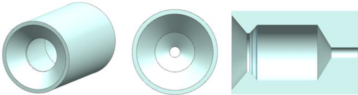
Figura 21: Ricevitore solare a cavità modellato in 3D
