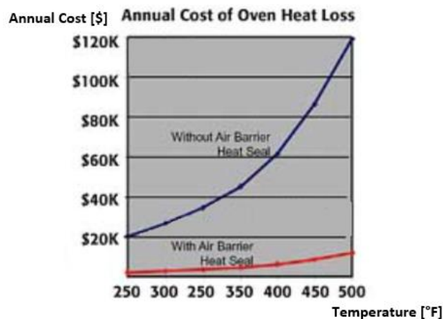
Grafico 1: Andamento dei costi in funzione della temperatura del forno durante l'apertura dello sportello [P.9]
