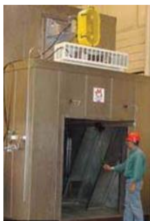
Figura 8: Forno industriale con porta a lama d'aria [P.8]
