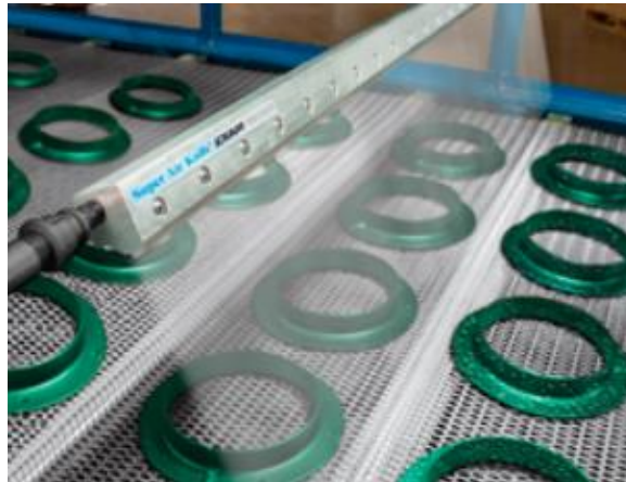
Figura 5: Asciugatura di componenti verniciati in una catena di produzione [P.5]
