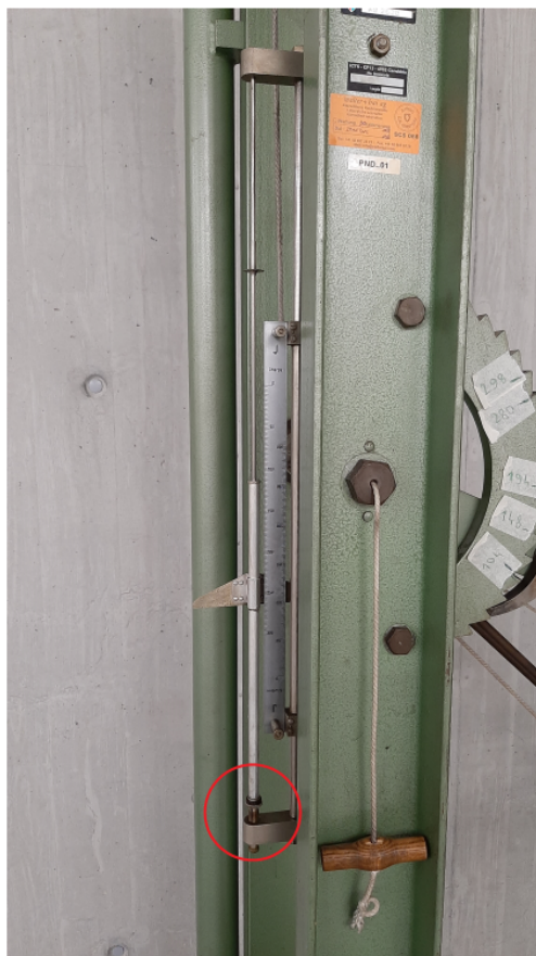
Figura 8.22: Regolazione vite scala graduata
