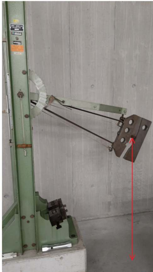
Figura 8.21: Misura altezza del centro di massa della mazza
