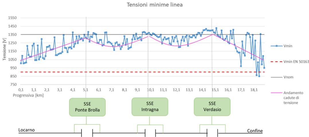
Figura 58 Andamento delle cadute di tensione lungo la linea (in fucsia)
