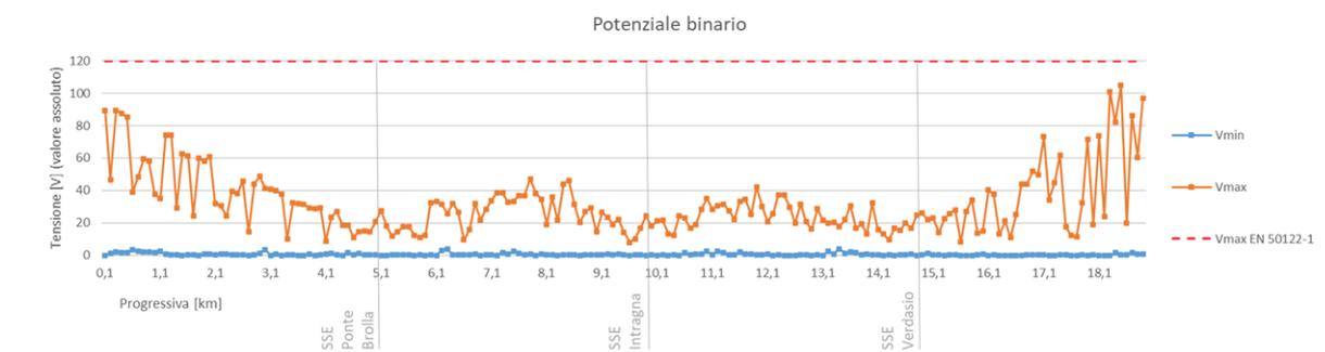
Figura 60 Potenziale di rotaia in funzione della progressiva
