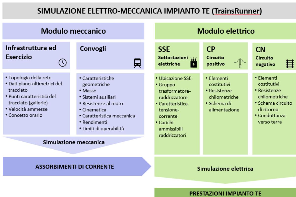
Figura 35 Diagramma di flusso TrainsRunner
