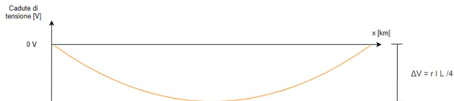
Figura 15 Cadute di tensione in funzione della posizione del convoglio, alimentazione bilatera
