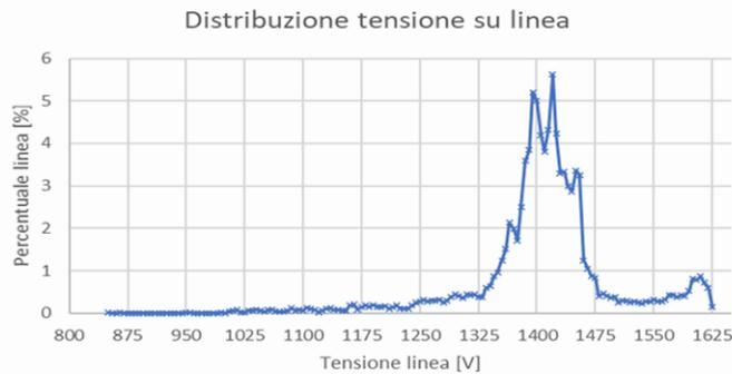
Figura 59 Distribuzione delle tensioni lungo la linea
