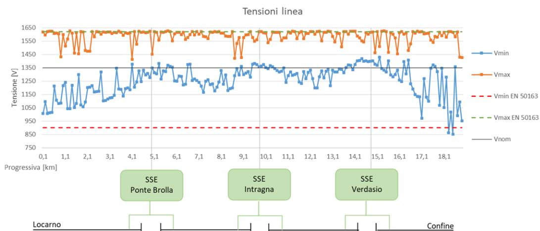
Figura 57 Tensioni linea in funzione della progressiva
