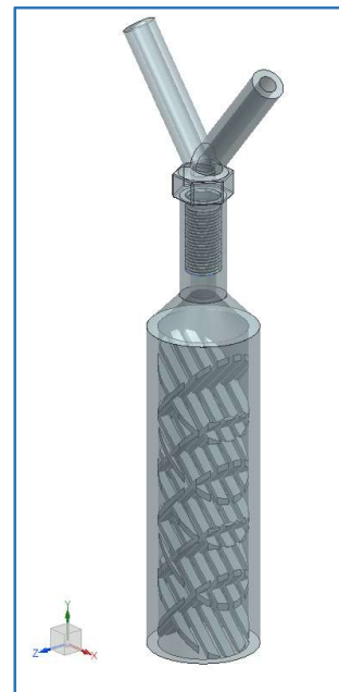
Figura 5.33: Geometria iniziale per raccordo ad Y più zona di miscelazione
