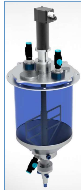
Figura 1.2: Tramoggia powder feeder di partenza
